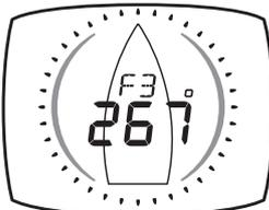
Die wahre Windgeschwindigkeit und -richtung über Grund werden in der Beaufort-Skala, unter Einbeziehen der Bootsgeschwindigkeit durchs Wasser und der Kompassanzeige, angezeigt.
