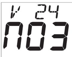
Anzeige für Instrumenten- Software- Version, Batterie-Ladezustand und Laderate, als Hinweise bei einer Fehlersuche. Ist das benutzte Instrument der „Master“ (das für die Auto- Vernetzung benutzte), wird die Gesamtzahl der im System vorhandenen Bauteile (nodes) gezeigt. Ist es ein
