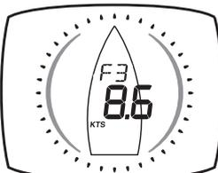
Die Windgeschwindigkeit über Grund wird in der Beaufort-Skala und in Knoten angezeigt.
