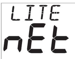
Bestimmung, ob die Instrumenten- Beleuchtung separat oder mit anderen Instrumenten im Netzwerk geregelt werden soll – **Network/ Local**.
