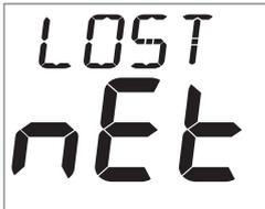
Erscheint der Alarm bei einem einzelnen Instrument, ist der Kontakt zum „Master“\* unterbrochen. Entweder wurde das auslösende Instrument aus dem Empfangsbereich entfernt, oder am "Master"\* - Instrument sind Probleme vorhanden. Zeigen mehrere Instrumente diesen Alarm, sind am "Master"\* Probleme aufgetreten oder der "Master"\* wurde aus dem Kontakt- Bereich entfernt. Die Instrumente werden anschließend in den Stromspar- Modus wechseln.
