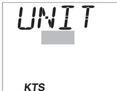
Maßeinheit, in der sämtliche Windangaben gezeigt werden: **Knoten (KTS)** oder Meter/ Sekunde (M/ S).
