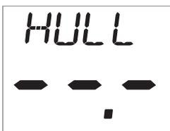
Zeigt Signalstärke und Batterie- Zustand vom Rumpfgeber. (Interessant für eine Fehlereinkreisung.)
