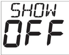
Aktivierung einer simulierten Anzeige für Demonstrations-Zwecke. Diese Funktion wird automatisch beim Ausschalten des Instrumentes wieder auf „**Off**“ gesetzt.
