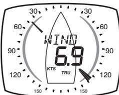
Die wahre Windrichtung und -geschwindigkeit in Bezug auf das Schiff, kalkuliert durch die Anzeige indem sie die Schiffsgeschwindigkeit durchs Wasser mit einbezieht. Scheinbare Windrichtung und -geschwindigkeit müssen für diese Berechnung verfügbar sein. Die Windrichtung wird in einer 360 Grad Skala angezeigt.
