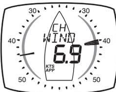
Der vom Windgeber gemessene Windwinkel, in Relation zur aktuellen Bootslage, dargestellt in einer gespreizten 0 bis 60°- Anzeige. Bei einer „Vor- dem- Wind“- Lage erscheint die Anzeige umgekehrt mit der Winkelanzeige in Relation zur rückwärtigen Bootsrichtung.
