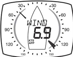
Die scheinbare Windrichtung und -geschwindigkeit in Bezug auf das Schiff, gemessen durch den Windgeber. Die Windrichtung wird in einer 260 Grad Skala angezeigt.
