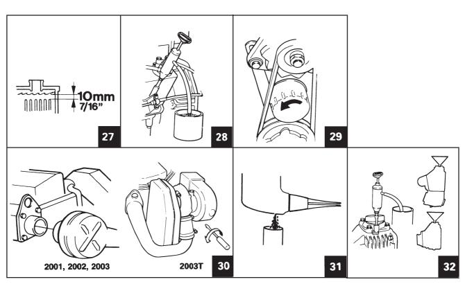
Das Öl entweder durch die Ablaßschrauben unter dem Wendegetriebe ablassen oder mit einer Öllenzpumpe durch die Öffnung für den Ölmeßstab absaugen. Öl einfüllen. Der Ölstand muß zwischen den beiden Ölstandmarken auf dem Ölmeßstab liegen. ACHTUNG! Nicht zuviel Öl nachfüllen! Für die Ölqualität und Füllmenge siehe die "Technischen Daten".
