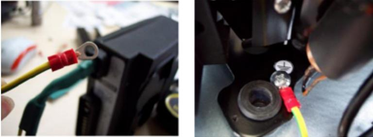
Abbildung 12: Detailansicht Erdungskabelanschluss am Metallgehäuse des Kompressors
