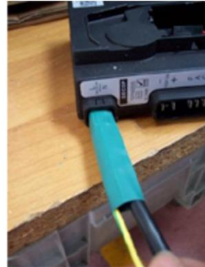
Abbildung 11: Detailansicht doppelt isolierter Anschluss
