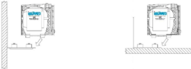
Installation an vertikaler Schottwand
